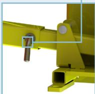
**Sabot de partie basse de béquille avec chape d'ancrage sur la dalle.**
