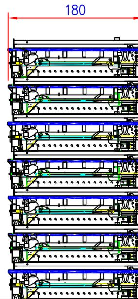
Empilage ferme sur ferme sur 7 niveaux maxi (sauf module M1 : 4 niveaux maxi).
