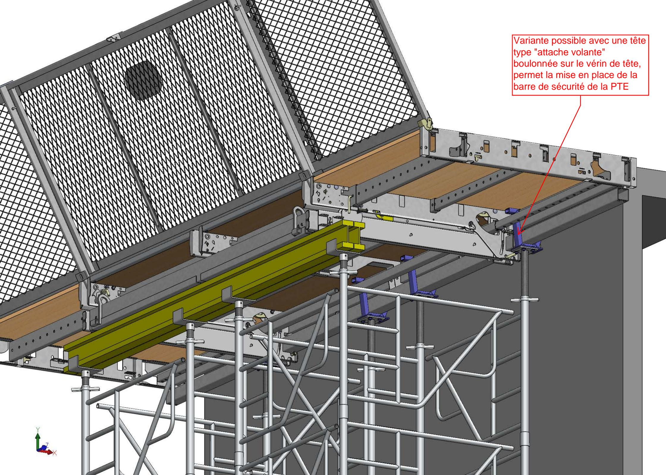
Variante possible avec une tête type "attache volante" boulonnée sur le vérin de tête, permet la mise en place de la barre de sécurité de la PTE
