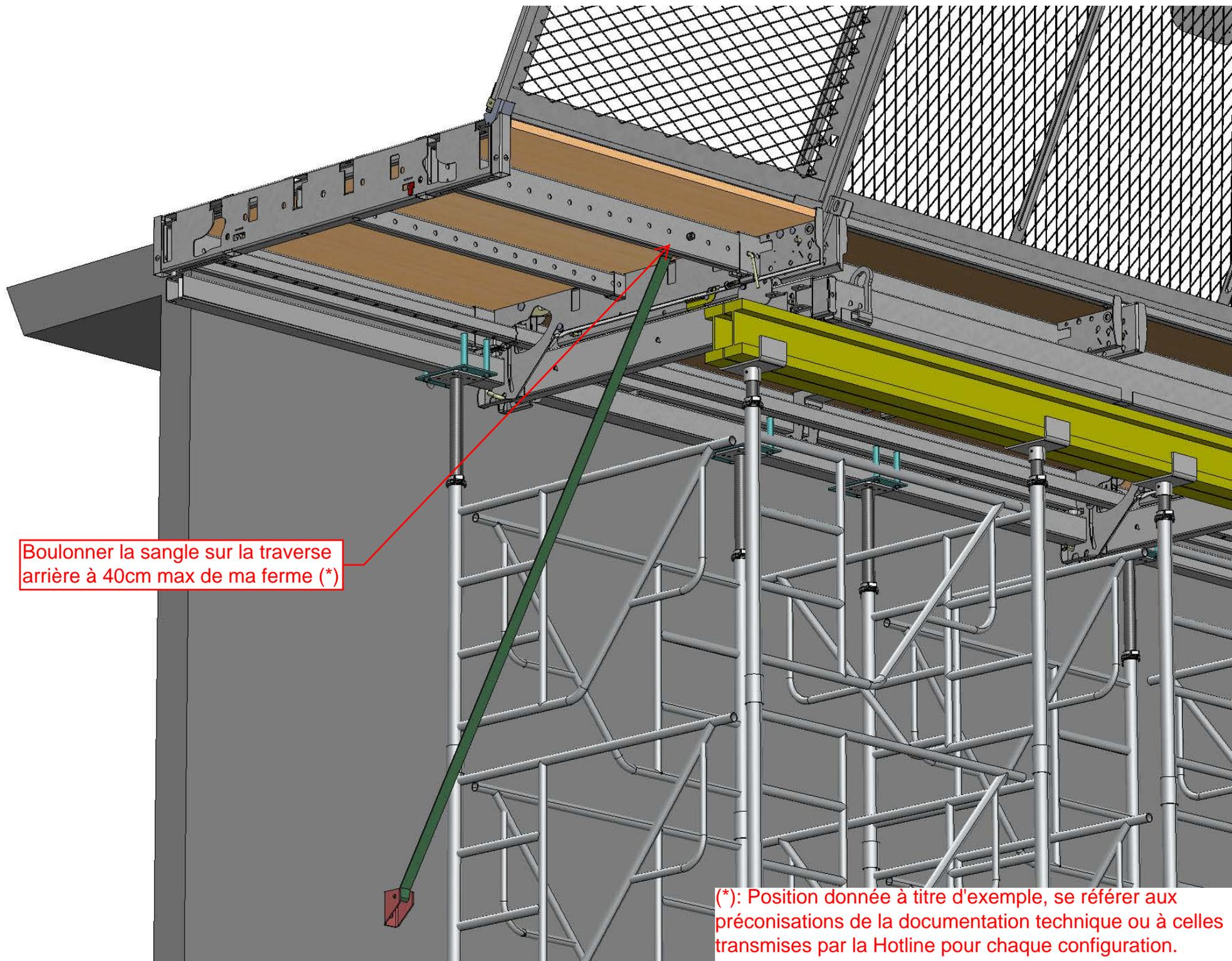
Boulonner la sangle sur la traverse arrière à 40cm max de ma ferme (\*)
