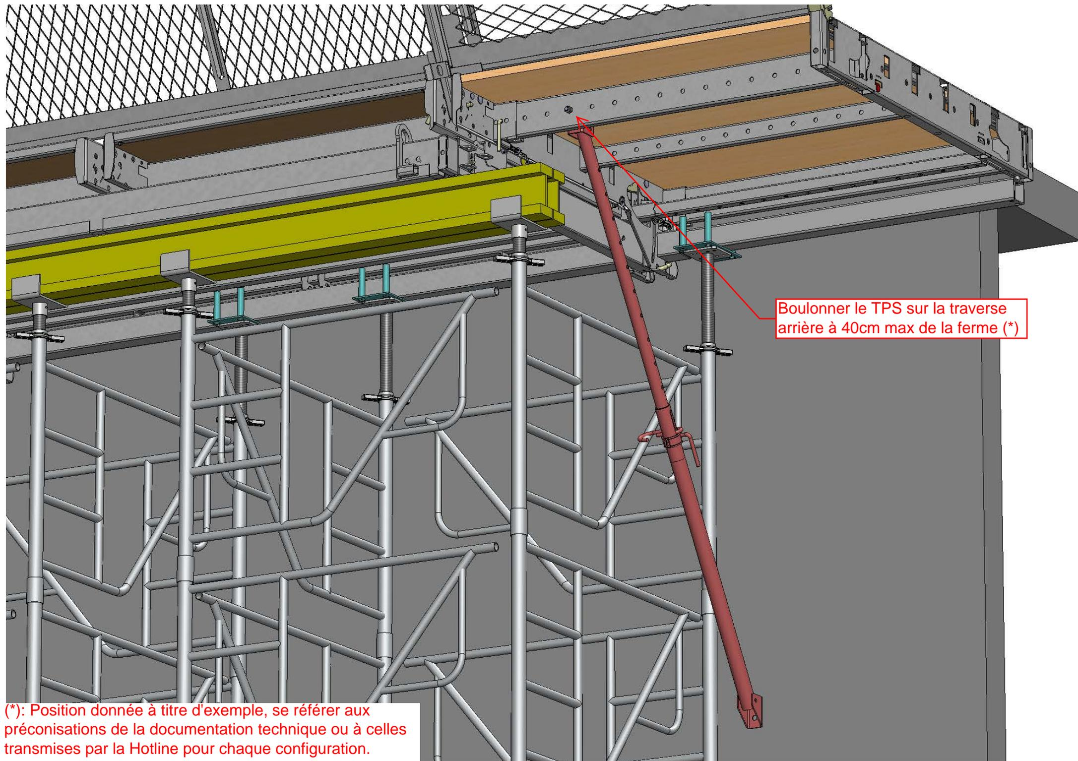
Boulonner le TPS sur la traverse arrière à 40cm max de la ferme (\*)
