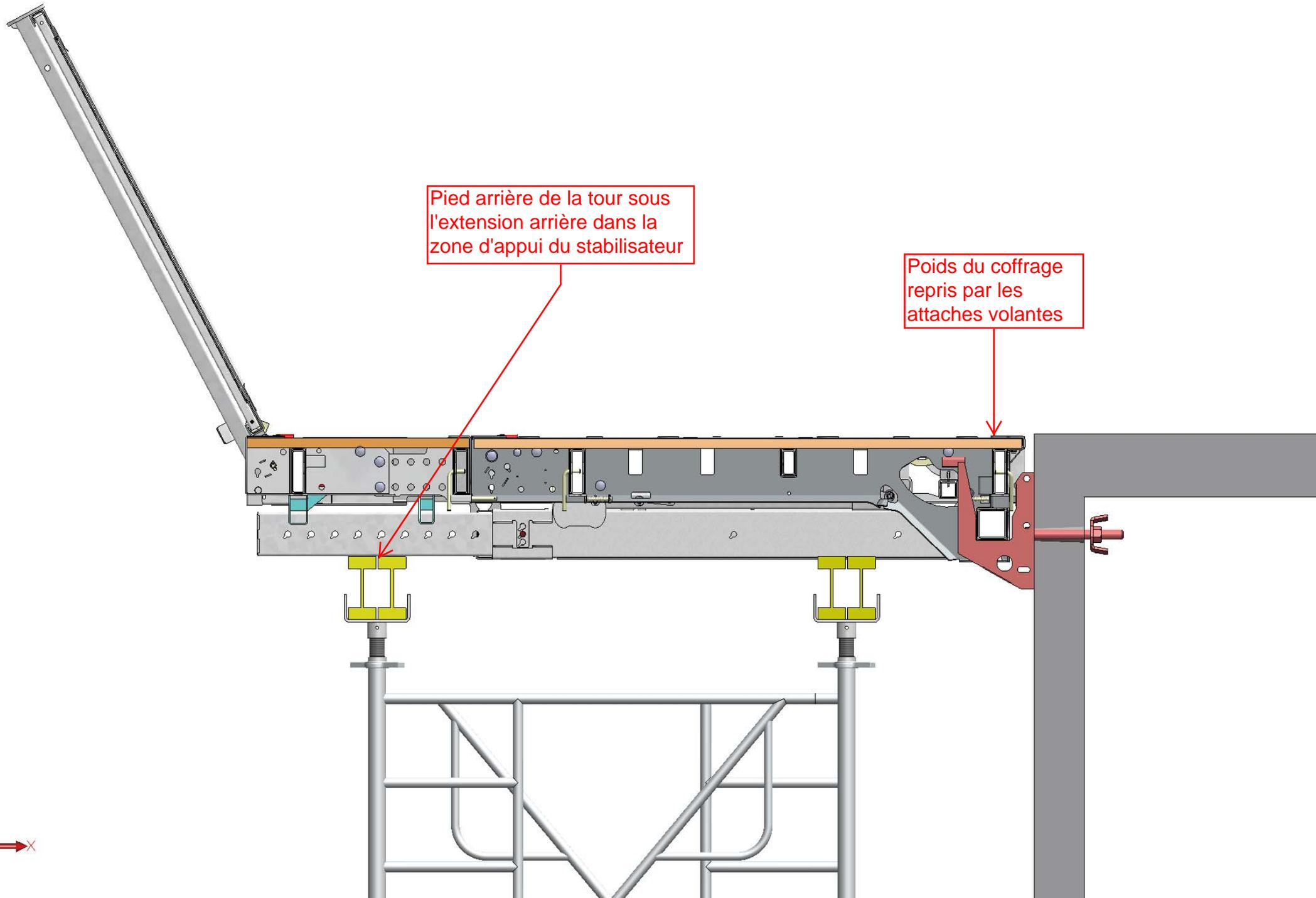
Pied arrière de la tour sous l'extension arrière dans la zone d'appui du stabilisateur
