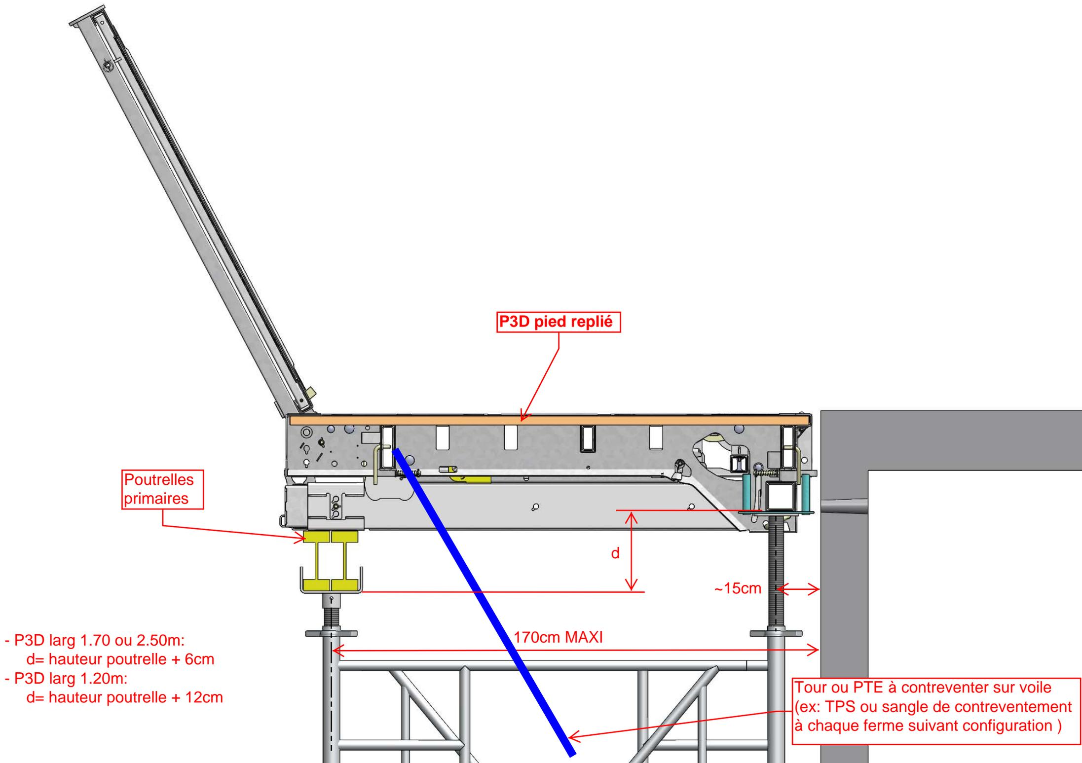
**Exemple d'ancrage de la plateforme par TPS**
