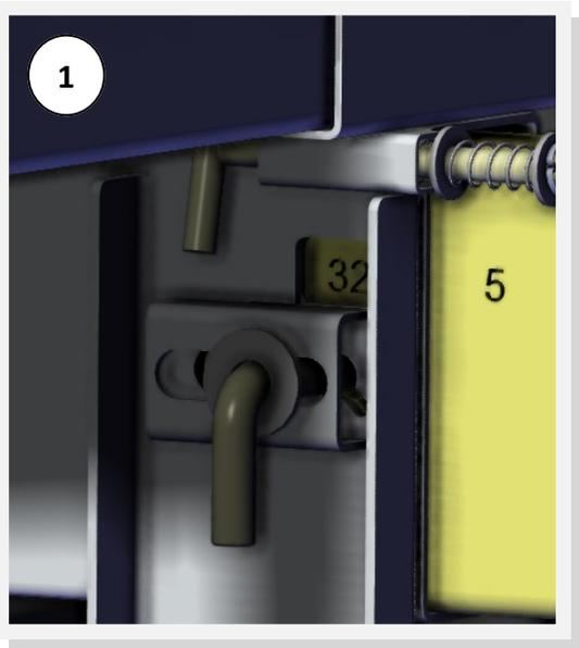
1- Remplacer les coulisses d'extension arrière standards par celles du kit profondeur (1). Régler la profondeur béton (Pb) et équilibrer l'espacement entre les traverses intermédiaires (2).
