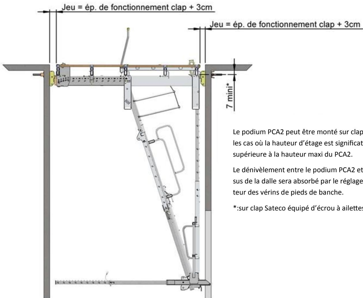
Le podium PCA2 peut être monté sur claps dans les cas où la hauteur d'étage est significativement supérieure à la hauteur maxi du PCA2.
