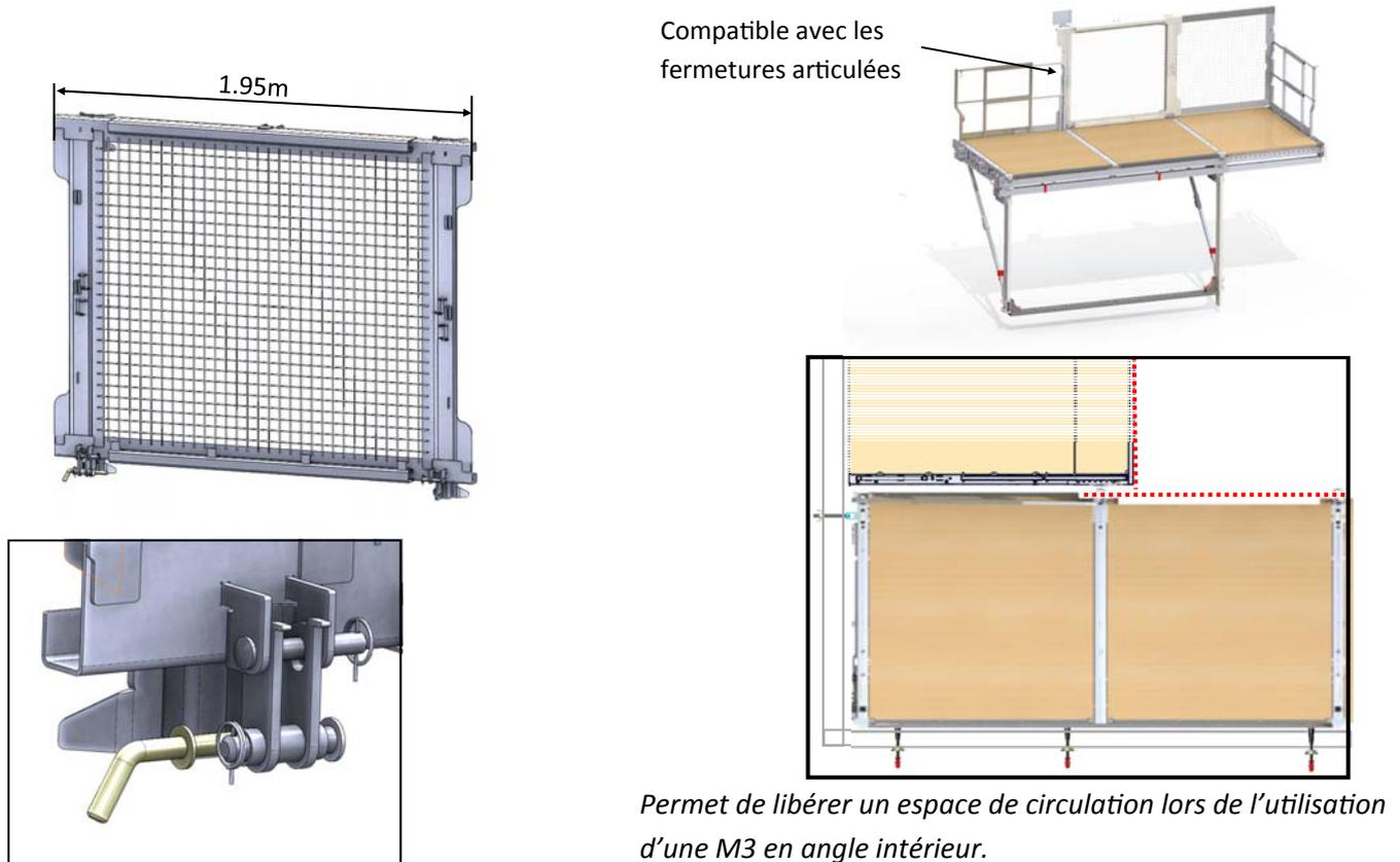
Montage identique aux auvents standards, une des fixations se fait sur la ferme centrale.
