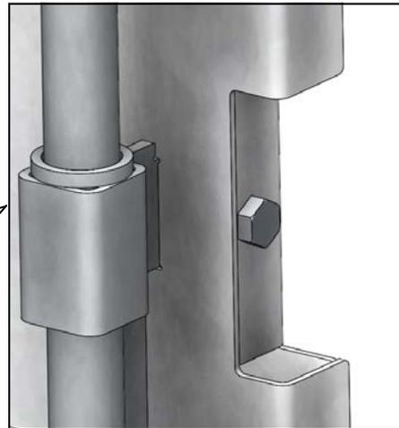
Fixation par boulons HM 12x70 sur l'auvent extensible.
