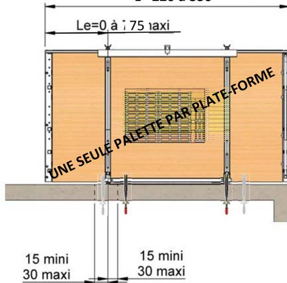
**M2 largeur 2m longueur 3.30m****1- PIED D'APPUI 1.84m****2- PIED D'APPUI 3.25m**
