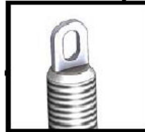
Le première tige doit être équipée d'un anneau de levage.
